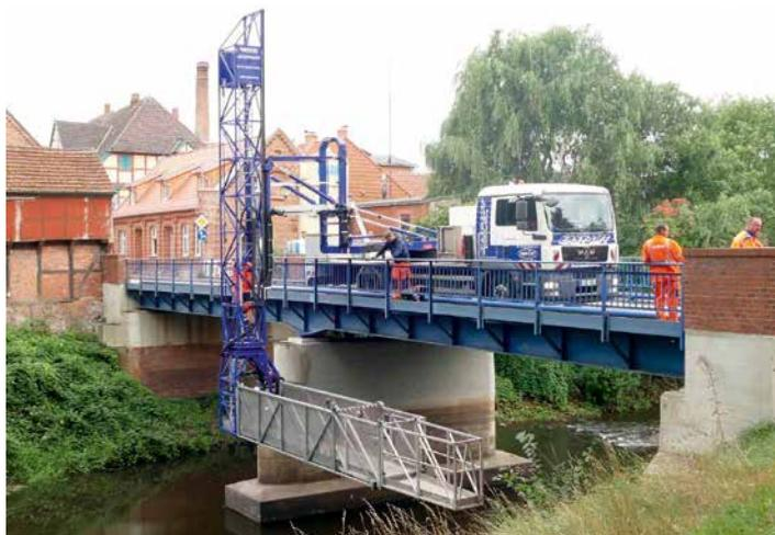
Für den Einsatz des Brückenuntersichtgeräts muss die Fahrbahn halbseitig gesperrt werden. Foto: strassen-mv.de
