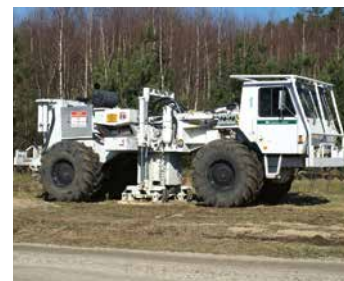
Vibrofahrzeuge erzeugen durch künstliche Erschütterungen seismische Wellen, die sich bis in die Tiefe fortbewegen.
