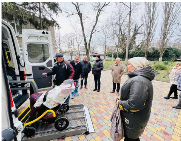
Mit einem Hydrauliklift lassen sich Rollstühle in den Kleinbus heben.
