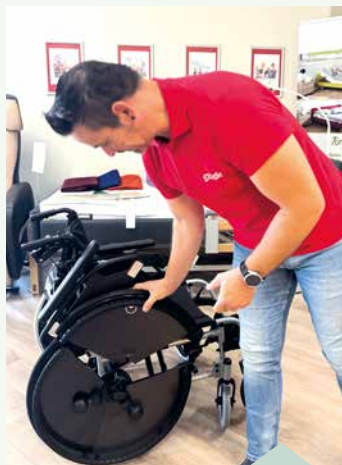
Das patentierte trivida-Rad lässt sich segmentweise abnehmen.
