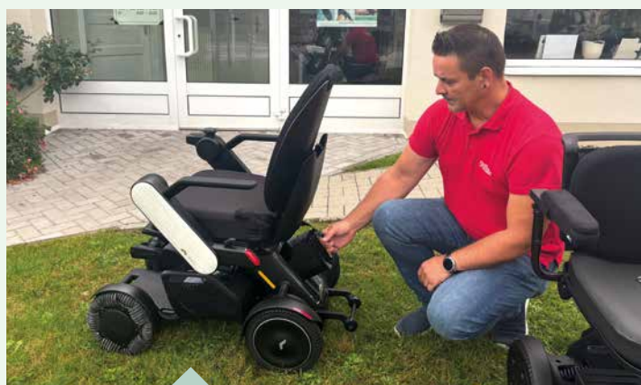
So einfach lässt sich der Akku aus dem Elektrorollstuhl entnehmen: Knopfdruck genügt.
